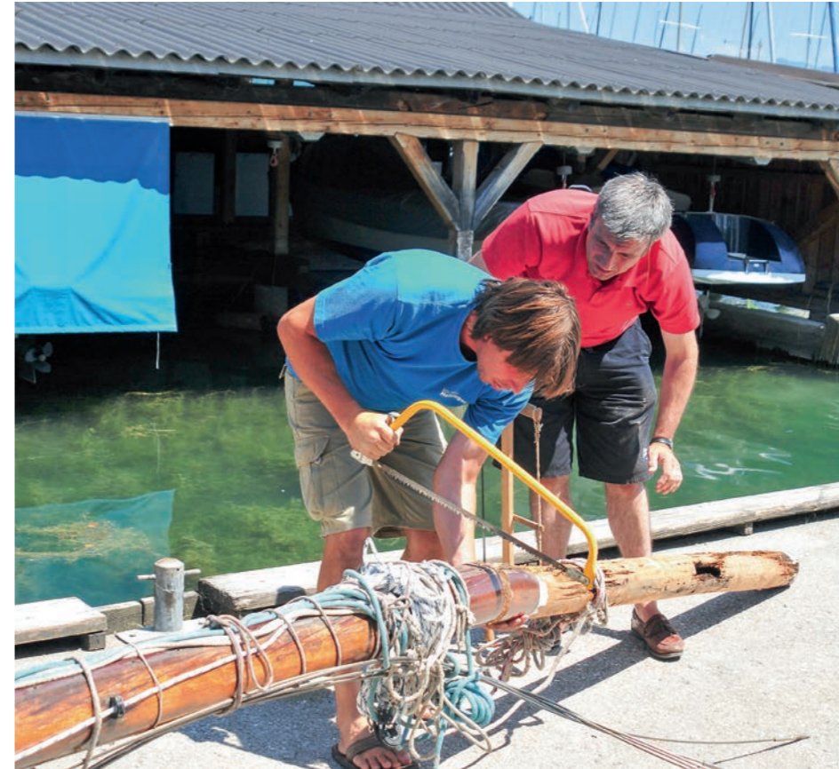
Mit diesem Mast sollte man besser nicht mehr segeln – das untere Ende war komplett verfault.
