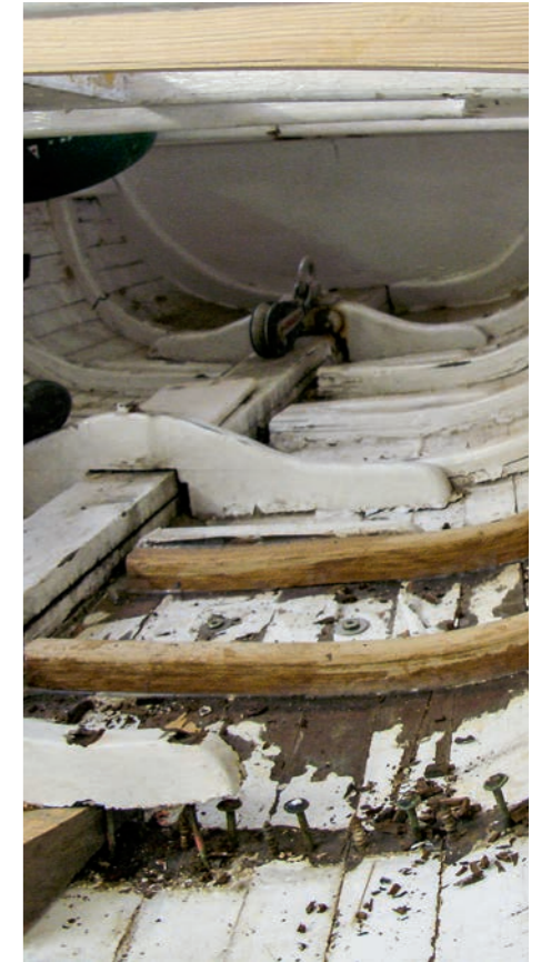
Nächste Katastrophe: Unter den Spanten waren die Planken faul. Bild: Privat
