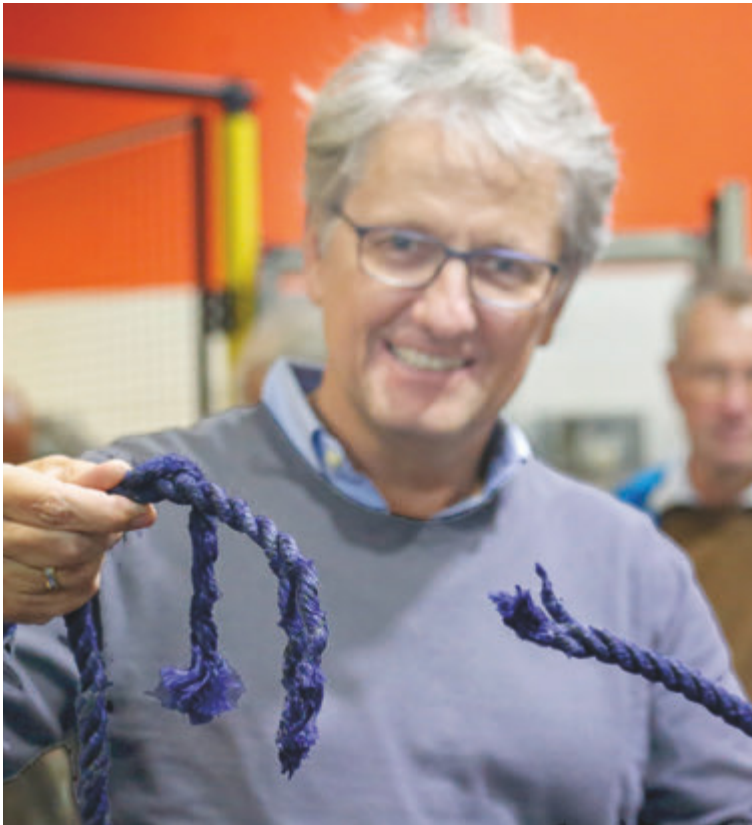
Gerissen. Im Prüfstand gerissene Festmacherleine der Windrose. Den Sturm Ende Oktober hätte sie auch nicht überlebt...
