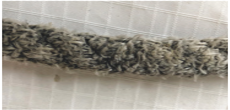
Alt, verwittert und aufgerieben. Diese Festmacherleine eines h26 im UYCA's hatte noch 20 % ihrer ursprünglichen Bruchlast.
