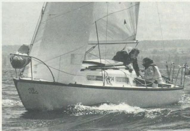
Speziell für Flachseereviere wurde 1972 ein Kielschwerter mit einem Tiefgang von 0,55 m konstruiert, der mühelos durch einen Normalkiel (Tiefgang 0,96 m) in ein Kielboot umgewandelt werden kann.
